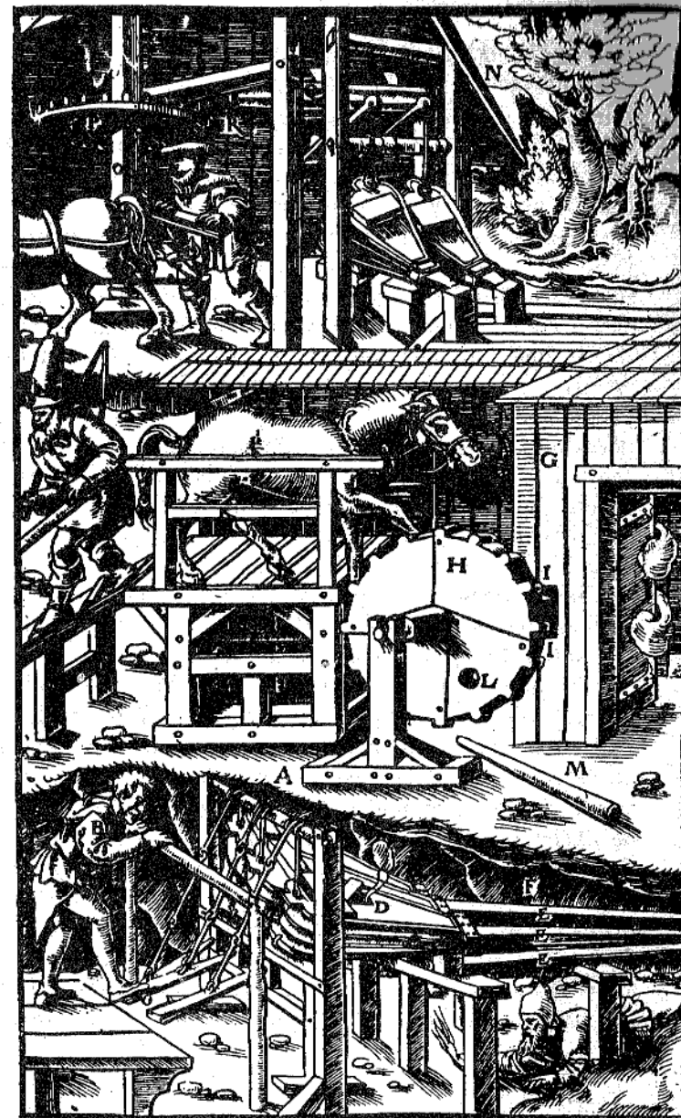
Máquina para introducir aire puro en las minas. Siglo XVI. G. Agrícola.
